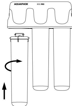
Для установки фильтрующего модуля:
