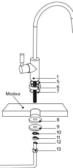
8. На трубку с латунной втулкой (12) наденьте накидную гайку (13) из комплекта крана для чистой воды, подсоедините трубку к крану и закрепите накидной гайкой.
