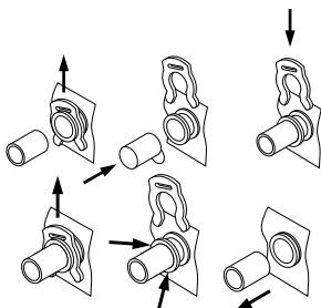
10. Соберите водоочиститель, установив модули в коллектор (см. раздел «Установка модулей»). Порядок установки модулей показан на «Схеме установки водоочистителя».
